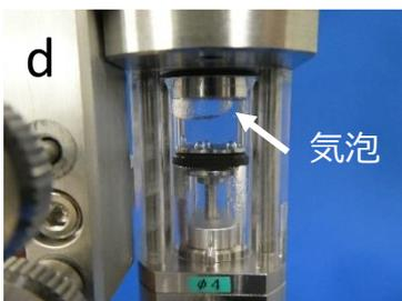
左写真dのような大きな気泡はサンプル吐出の際の脈動の原因となるので、上記写真cのように水の入ったシリンジを使って取り除く。
