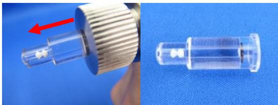
サンプルの入ったシリンジのプランジャーを押し、シリンジ内のサンプルをカートリッジに移す。治具を外してカートリッジを取り出す。
