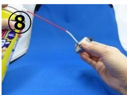
ガスフォーカス用の穴にエアダスターを付け、パーツ内部に残っている洗浄液を吹き飛ばす。
