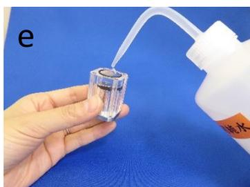
上記の方法でも気泡が気になる時はハッチへ取り付けのためのアダプターを外し（ネジ二つ）、更にHPLCポンプのコネクターが付いたパーツの4つのネジを外す。左写真eのように洗瓶から直接、水をたっぷり入れ、あふれさせながら再び組み立てていく。
