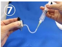
ガスフォーカス用の穴に洗浄液の入ったディスプレイシリンジを取り付け、5 mL程度、勢いよく注入する。
