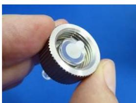
治具の片方（メス）に挿し込み、シリンジアダプターをのせる。
